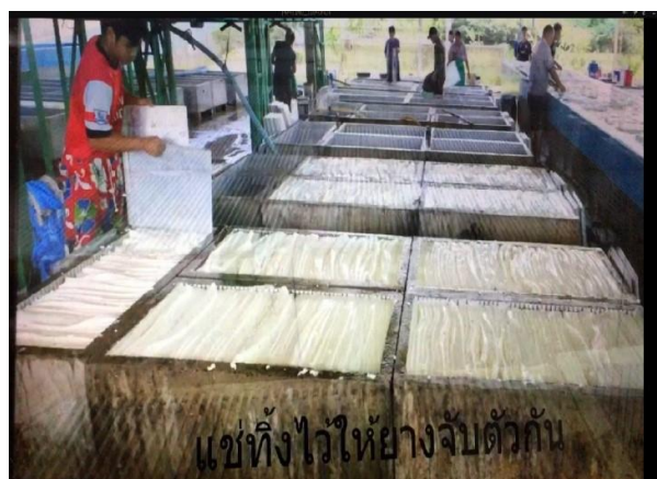
Hình 3.26: Đánh đông mủ bằng hồ với tấm chắn rời được định vị
