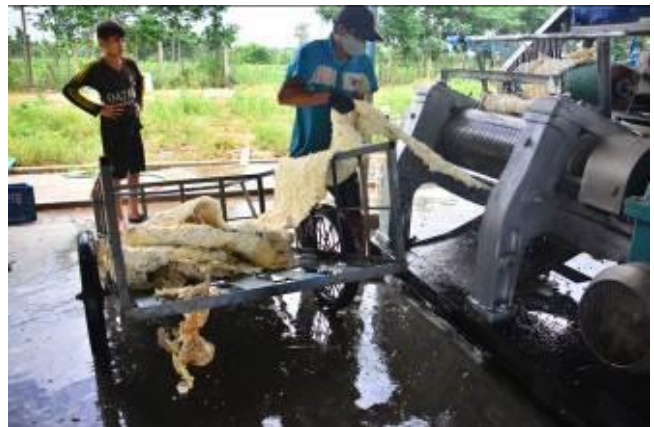
Cán tạo tờ mũ đồng sau cắt, băm
