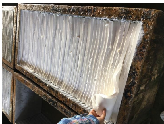
Hình 3.26: Đánh đông mủ bằng hồ với tấm chắn rời được định vị
