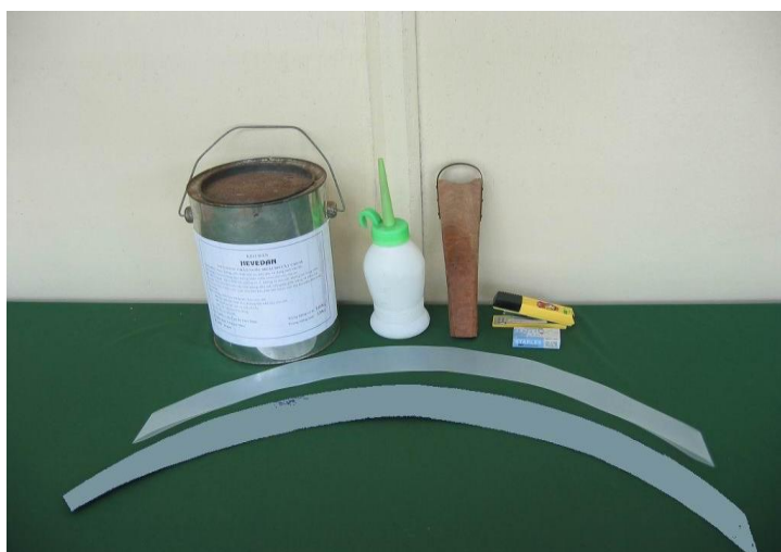
Hình 2.12: Dụng cụ gắn máng chắn nước mưa và các loại máng, mái che mưa
